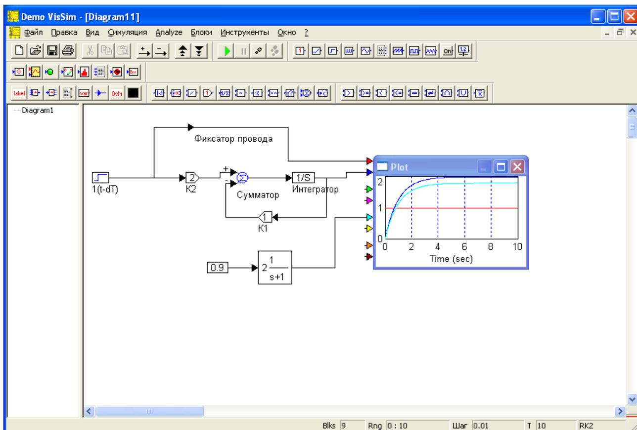
Рисунок 5.2 – Эквивалентная модель аperiodического звена
