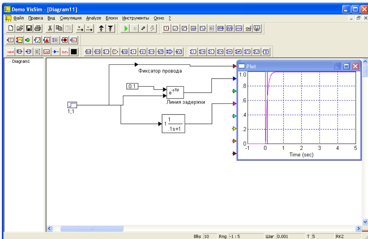
Рисунок 7.2 – Аппроксимация звена запаздывания аperiодическим звеном  $T=\tau=0.1$
