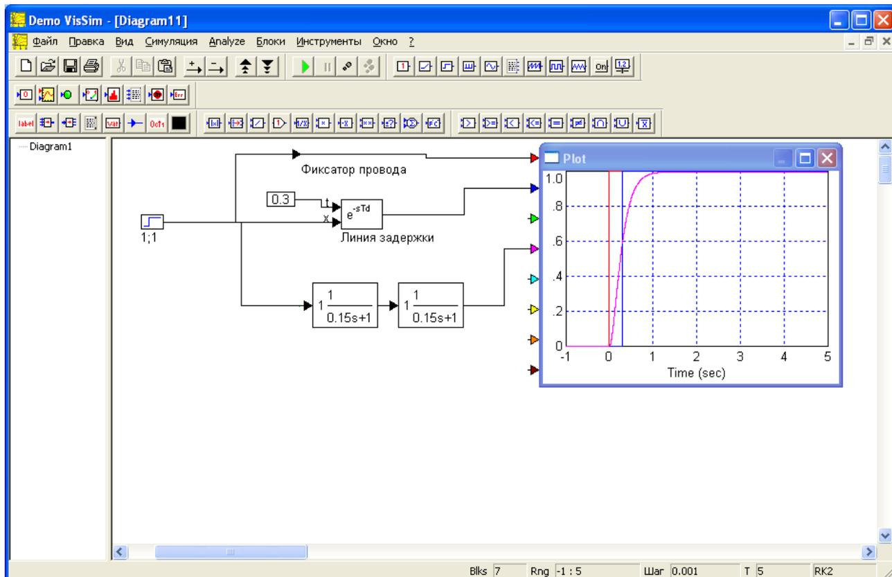
Рисунок 7.3 - Аппроксимация звена запаздывания двумя аperiодическими звеньями
