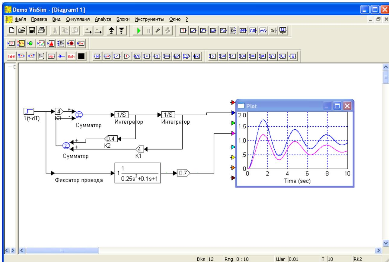
Рисунок 6.2 – Эквивалентная модель колебательного звена
