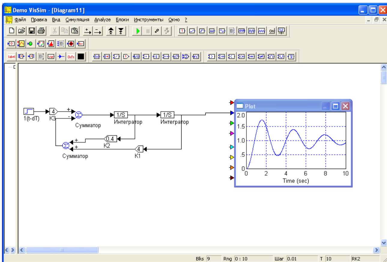
Рисунок 6.1 – Модель колебательного звена
