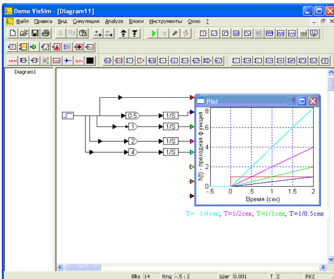
Рисунок 4.2 – Исследование нескольких интеграторов
