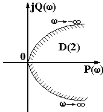
Рисунок 2.1 - Кривая  $D$ -разбиения для анализа устойчивости системы с характеристическим уравнением  $p^2 + 2p + k = 0$  в плоскости параметра  $k$ .
